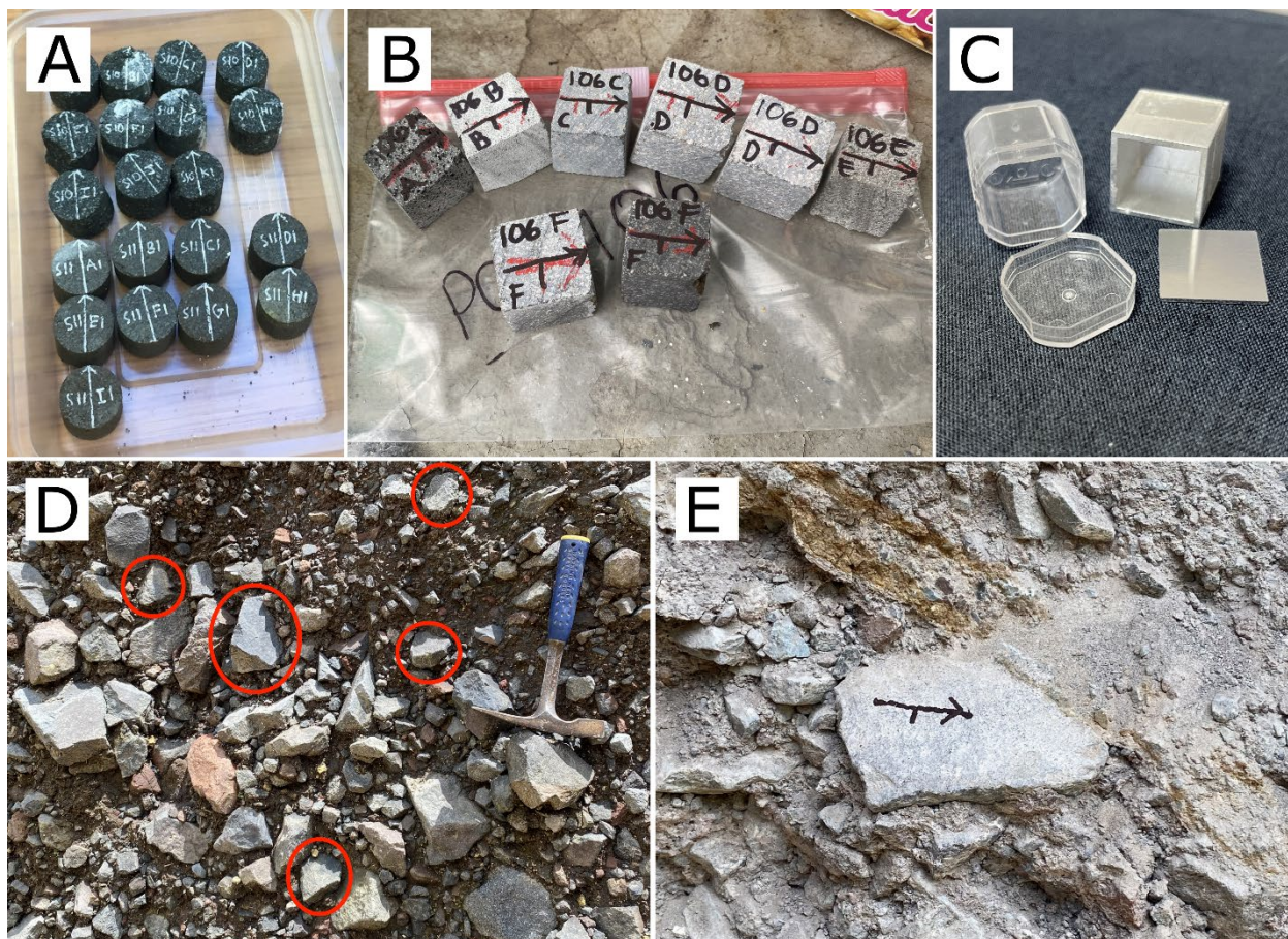
620 Figura 6: Fotografías de las características más importantes de muestras y especímenes paleomagnéticos. [A] ejemplo de un espécimen cilíndrico de roca de diámetro de 25 mm y espesor de 25 mm, [B] ejemplo de un espécimen cubico de roca de 2 x 2 x 2 mm, [C] cubos de plástico y metal especializados para toma de muestras cubicas de matriz de 2 x 2 x 2 mm, [D] afloramiento de un depósito de CDP donde se pueden apreciar clastos factibles para el muestreo, [E] ejemplo de una muestra de mano ideal, nótese la superficie plana de la roca que es ideal para medir y etiquetar.
