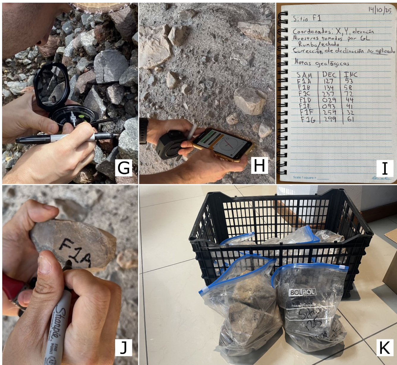
Figura 8: Pasos para coleccionar muestras paleomagnéticas orientadas de un depósito piroclástico. [A] ejemplo de la información que se debe tomar en la libreta de campo para registrar el muestreo y orientación, [B] identificación de clastos ideales para muestreo en el afloramiento, [C] ejemplo de un afloramiento con un clasto cuya superficie plana se inclina hacia adelante del afloramiento (círculo rojo) y un clasto con una superficie invertida (círculo azul), [D] limpieza del área alrededor de la muestra y de la superficie de una muestra antes de orientar y etiquetar, [E] uso del marcador permanente para dibujar una flecha de rumbo paralelo a la medición tomada con la brújula, [F] clasto con la flecha de rumbo marcada (indicado por la flecha roja) y línea pequeña perpendicular a la flecha de rumbo en la dirección del echado de la superficie plana de la muestra (indicado por la flecha pequeña negra), [G] medición de la declinación de la muestra con la brújula geológica, [H] medición de la declinación e inclinación
