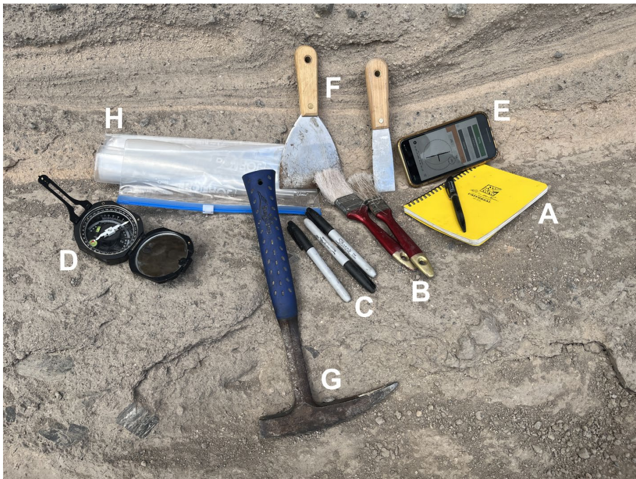
655 Figura 7: Equipo esencial para el muestreo paleomagnético de depósitos piroclásticos. [A] libreta de campo, [B] cepillos o brochas de tamaños variados para limpiar las muestras de roca antes de etiquetarlas, [C] marcadores permanentes para etiquetar, d) ejemplo de una brújula geológica con clinómetro para orientar muestras, [E] ejemplo de un aplicación de smartphone de brújula-clinómetro que también se puede utilizar para orientar 660 muestras, [F] espátulas metálicos de tamaños variados para limpiar el afloramiento y las muestras, [G] martillo/pica geológica para limpiar el área alrededor de la muestra y extraer la muestra del afloramiento, [H] bolsas de tela y plástico para organizar las muestras orientadas.
